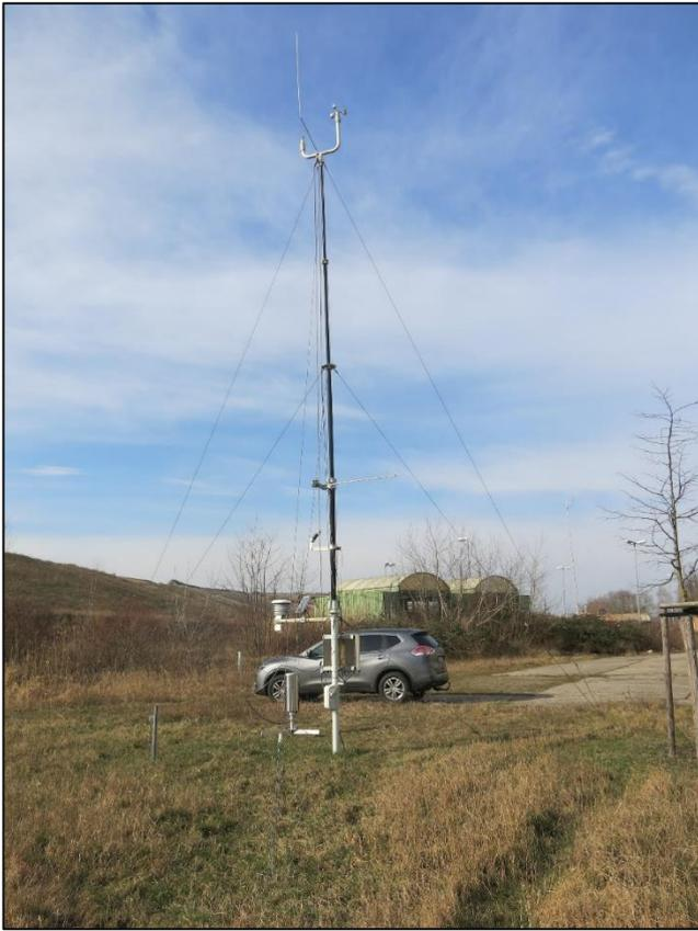
Abb. 2 - 10-Meter-Klimastation der MME
