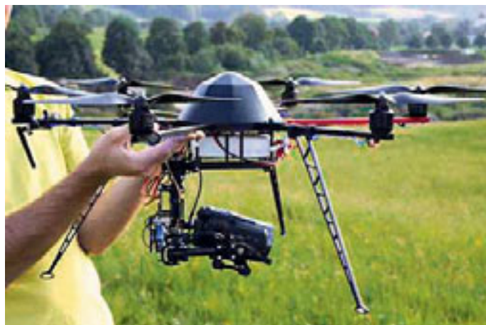
Erfolgreich schon im Einsatz, der Hexacopter der Bergwacht mit hochauflösender Kamera zur Lageerkundung in schwer zugänglichem Gelände und zur Unterstützung bei Sucheinsätzen.
