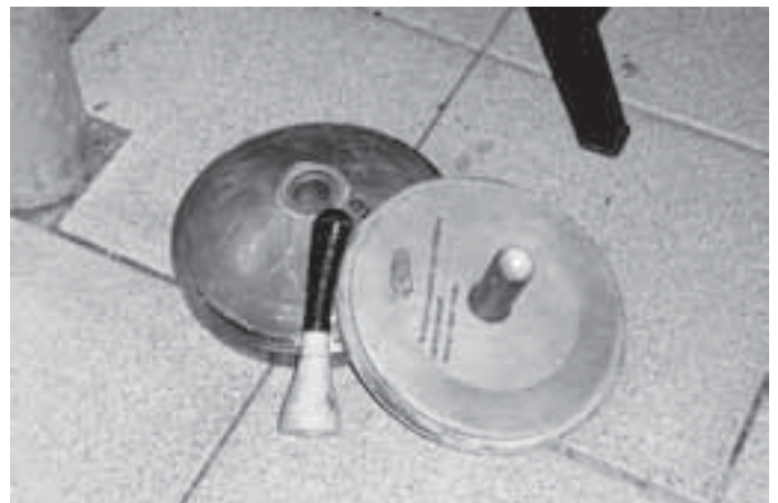
Stockbruch durch „harten“ Einsatz
