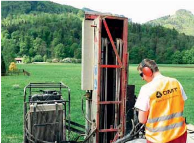
Die Messstelle für den Hammer wird genau justiert. © OVB
