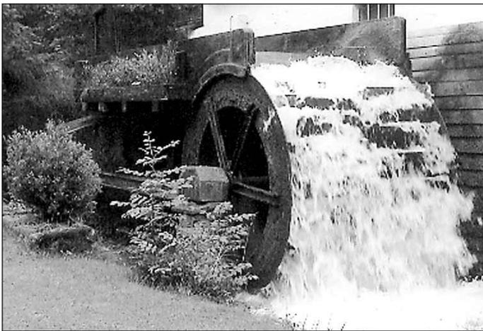
*Das Wasserrad der Hammerschmiede*
