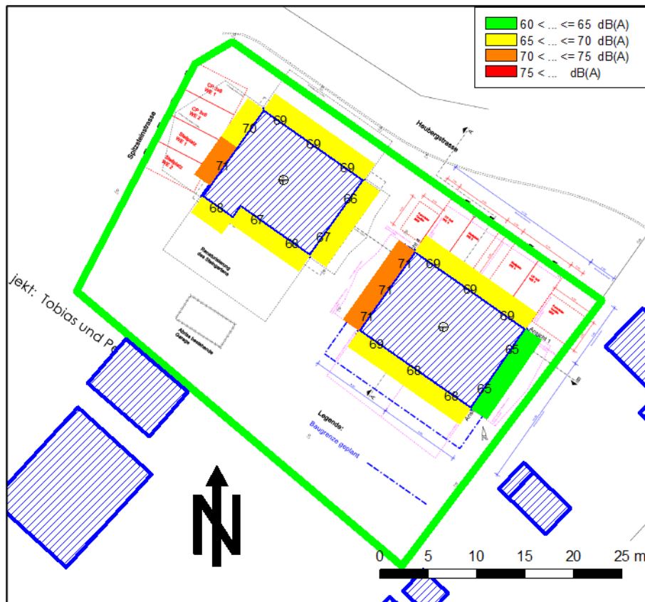
Abbildung 6. Maßgebliche Außenlärmpegel nach DIN 4109 für das lauteste Stockwerk.
